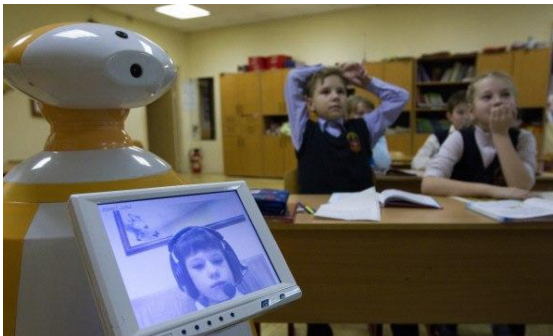
Рис. 6. Пример робототехнической системы дистанционного присутствия – робот «R-Bot» ( http://rbot100.rbot.ru )
